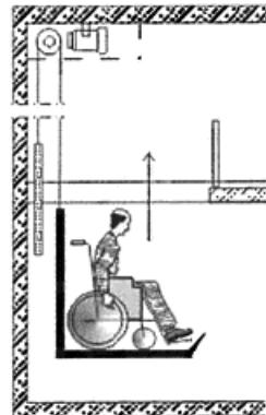
Шахтный подъемник с закрытой платформой
