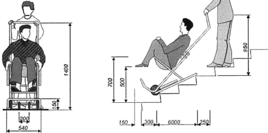
*Рисунок В.34 - Автономные транспортные устройства*
