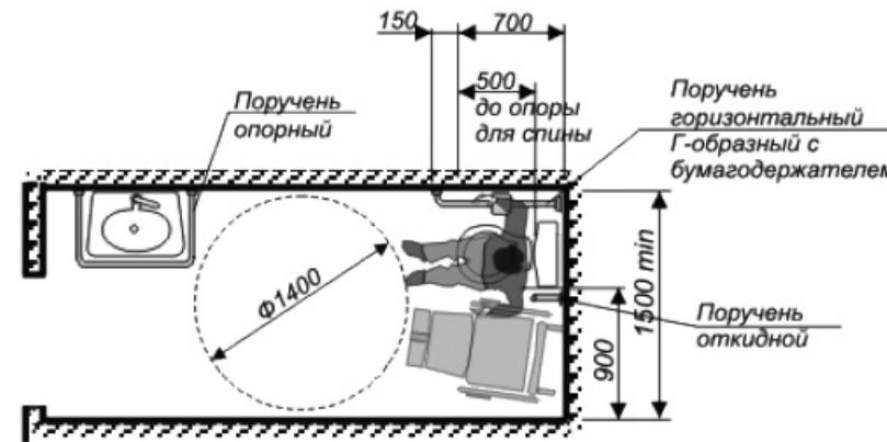
**Рисунок Г.12 - Примеры оборудования совмещенного санитарного узла**
