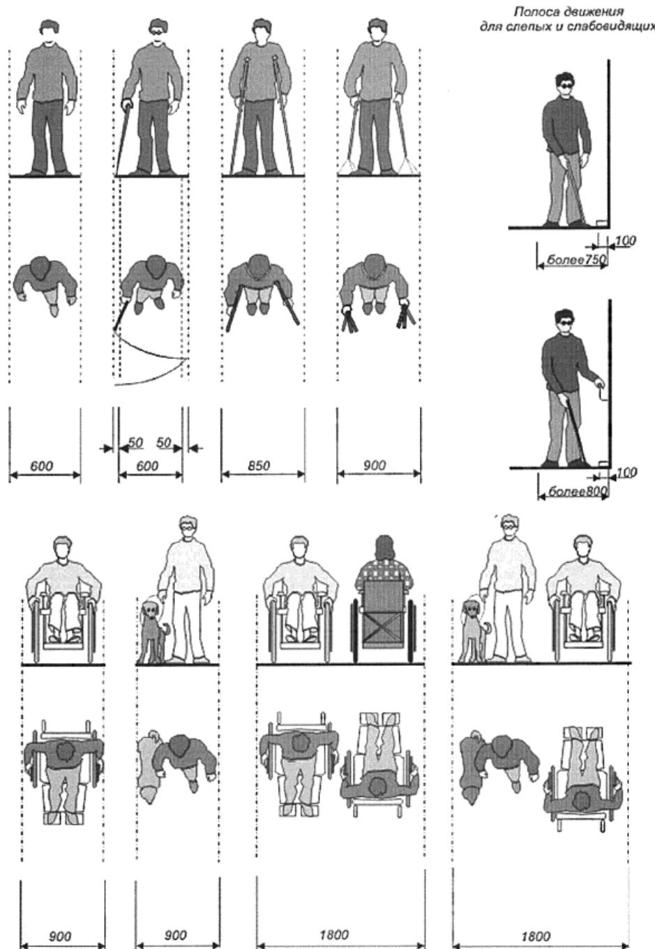
**Рисунок В.11 - Габариты полосы движения**
