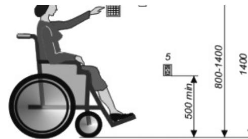
1 - домофон; 2 - термостат кондиционера; 3 - пожарная сигнализация; 4 - выключатель; 5 - электрическая розетка; 6 - табло, часы, бегущая строка
