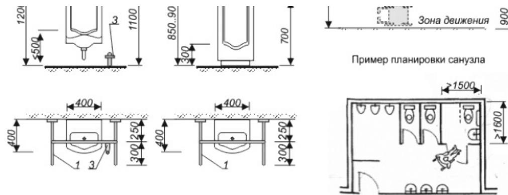
1 - поручни опоры; 2 - смывной кран (ручной); 3 - смывной кран (ножной);
