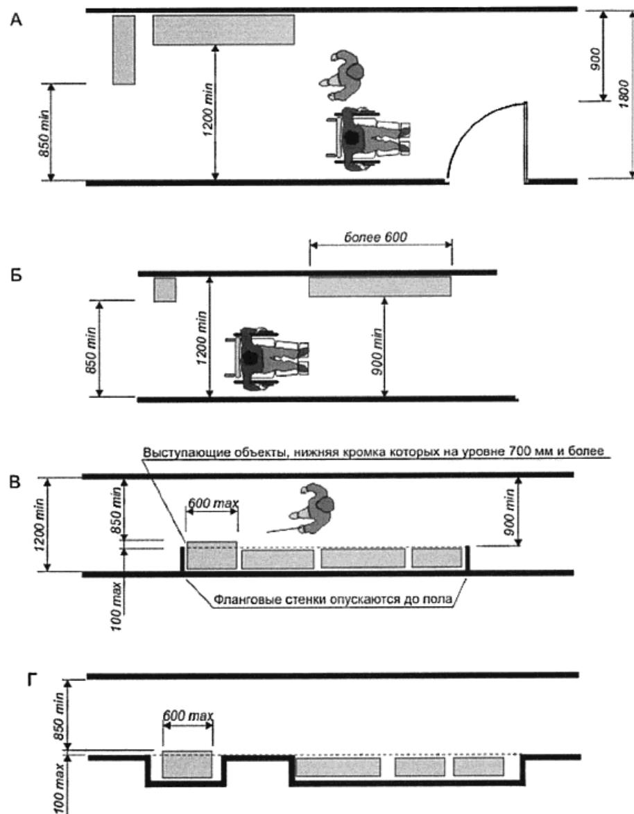
А, Б - сохранение пропускной способности коридоров; В - безопасное размещение смонтированных на стене объектов;
