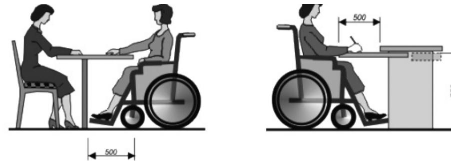
**Рисунок Г.2 - Параметры досягаемости в месте получения услуги**
