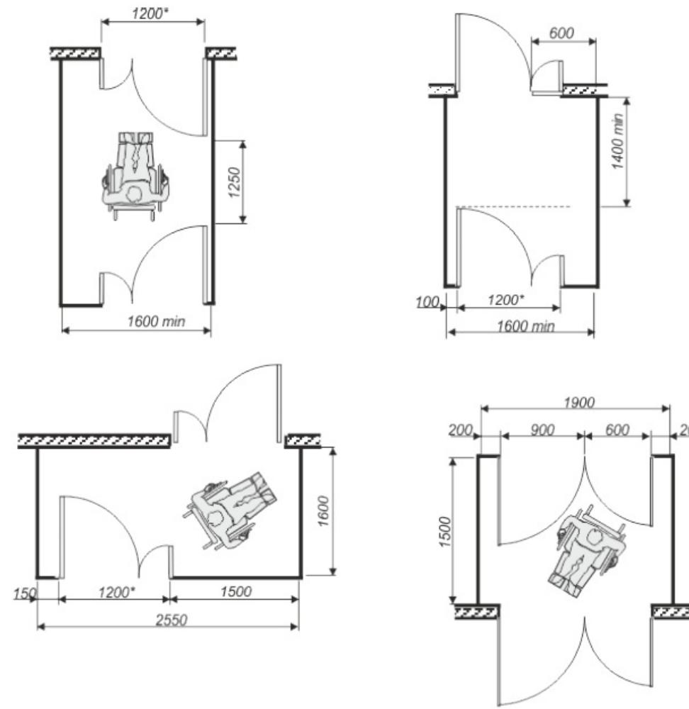
Измерение проемов входных дверей
