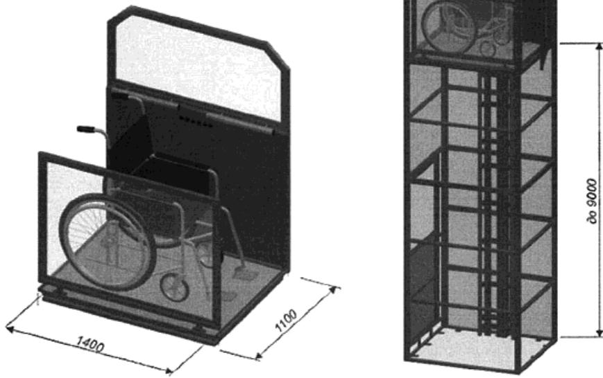
*Рисунок В.33 - Параметры вертикальных подъемников*
