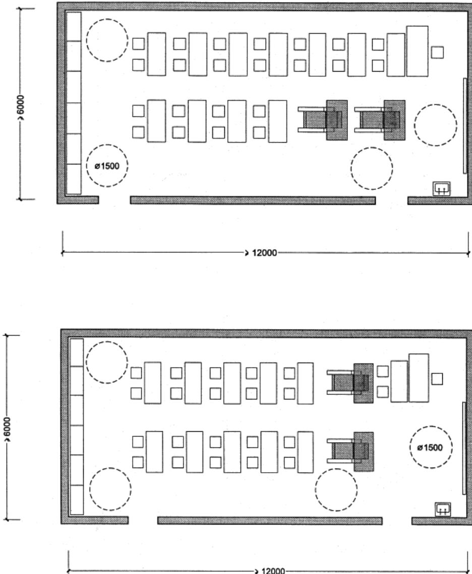
**Рисунок Б.3 - Варианты планировочных решений классных помещений площадью 60-70 м<sup>2</sup>**
