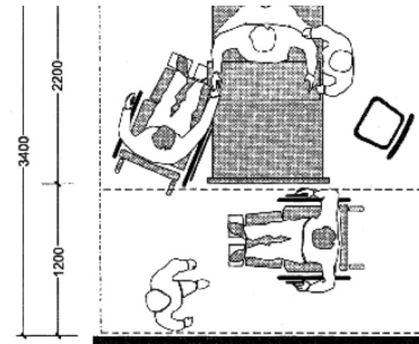
Рисунок Б.13 - Зоны обслуживания и зоны проезда в палатах для лежачих больных
