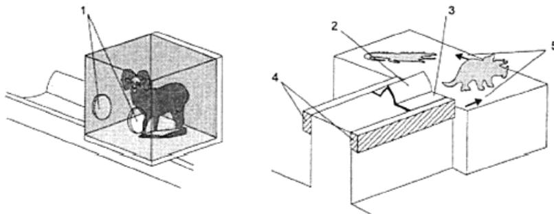
1 - безопасный ящик для ценных экспонатов с отверстиями для рук; 2 - крупный заголовок, расположенный под прямым углом к лучу зрения; 3 - надписи на брайлевском шрифте для горизонтального чтения; 4 - непрерывный деревянный поручень с округленными и обработанными краями (800 мм от пола);
