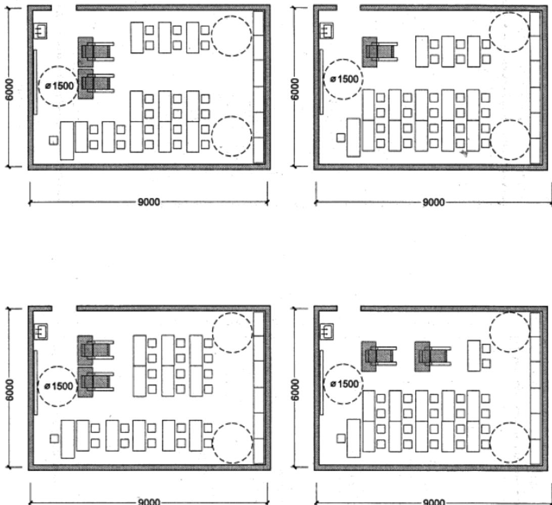
**Рисунок Б.2 - Варианты планировочных решений классных помещений площадью около 50 м<sup>2</sup>**
